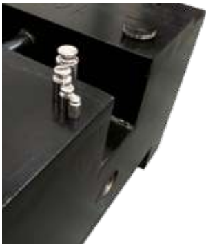
Aussparung zur Kalibrierung der Gewichte
