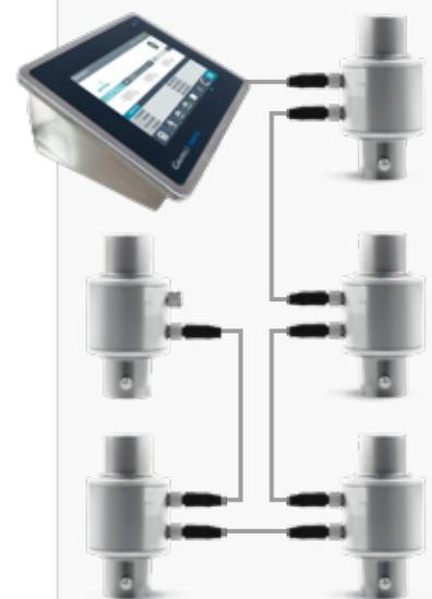
Beispielhaftes Installationsdiagramm mit einem Anzeigerät **GI650D** und Wägezellen **G8RD Dual**
